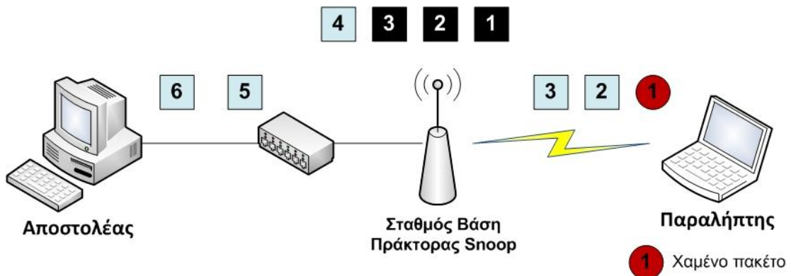
Σχήμα 3.4 Παράδειγμα αποστολής δεδομένων χρησιμοποιώντας το πρωτόκολλο Snoop
