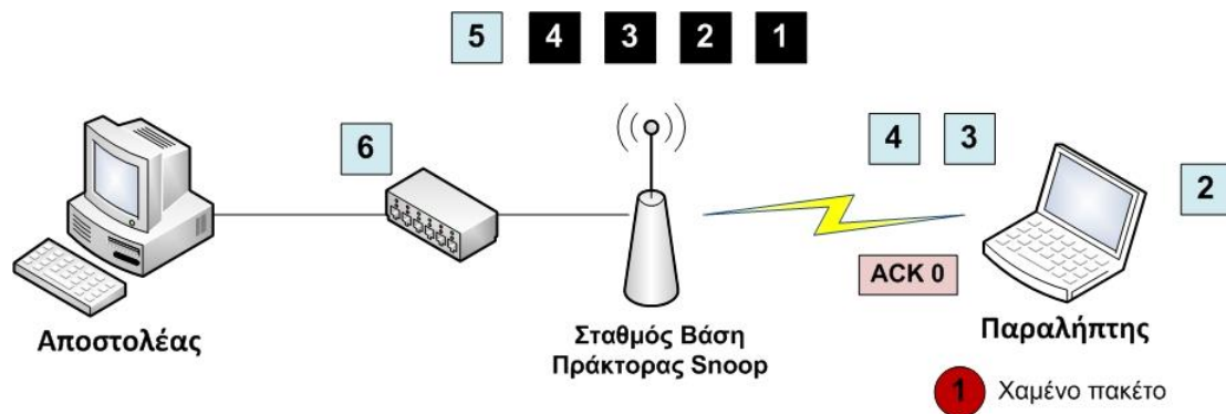
Σχήμα 3.6 Παράδειγμα αποστολής δεδομένων χρησιμοποιώντας το πρωτόκολλο Stop-and-Wait
