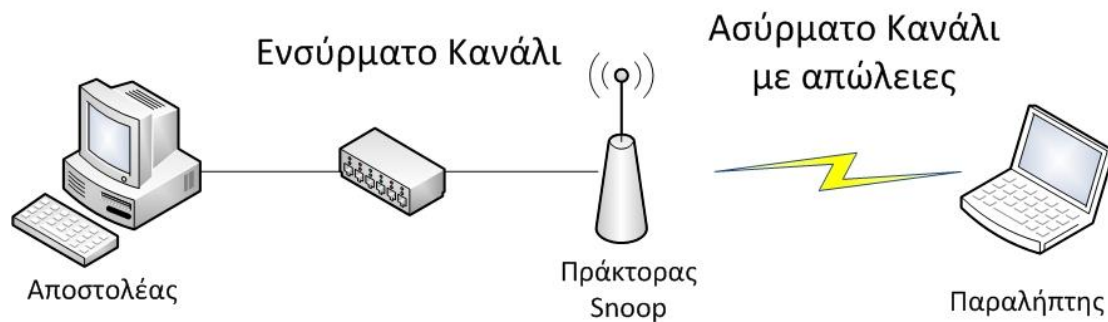
Σχήμα 3.1 Τοπολογία εφαρμογής του πρωτοκόλλου Snooper
